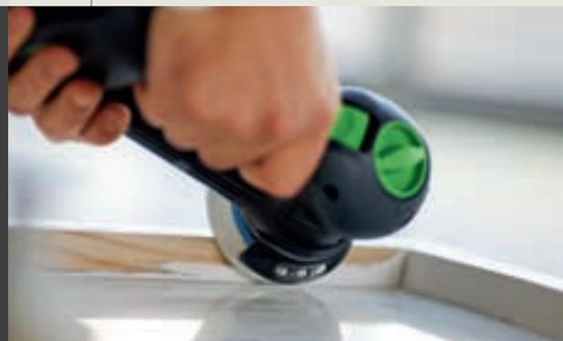
Уверенное шлифование без отдачи вплоть до кромок стыков с помощью Festool PROTECTOR.
