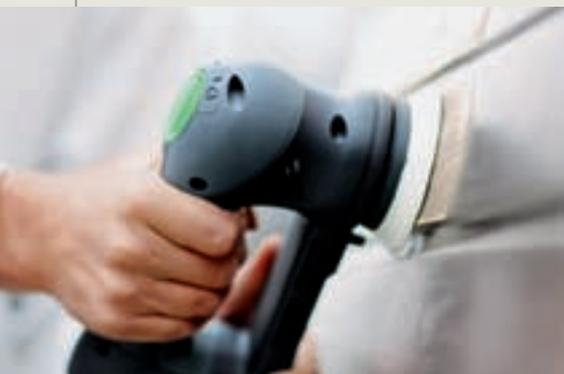
Быстрый результат за один рабочий ход: новый диаметр тарелки 90 мм оптимизирован для оконных рам, а также шпунтовых и шпоночных соединений.
